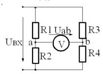
Входное напряжение равно 6 В. Сопротивления резисторов: R1=2 Ом, R2=4 Ом, R3=4 Ом, R4=2 Ом. Чему равно напряжение Uab, измеряемое вольтметром?
