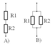
При последовательном соединении резисторов R1 и R2 (вариант"A") входное сопротивление равно 50 Ом, а при параллельном соединении их же-12 Ом. Определить R1 и R2
