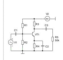
**1.** Приближенным методом рассчитать параметры компонентов для задания режима по постоянному току, обеспечивающего получение максимальной амплитуды выходного напряжения. Напряжение питания 10 B, коэффициент передачи тока транзистора  $\beta$ =50...100.
