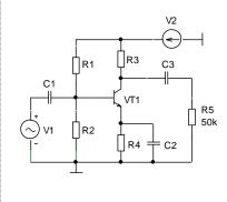
**2.** Графоаналитическим методом рассчитать параметры компонентов для задания режима по постоянному току, обеспечивающего получение максимальной амплитуды выходного напряжения. Напряжение питания 15 В.
