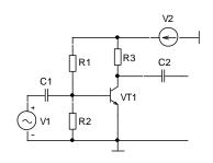
**5.** Приближенным методом рассчитать параметры компонентов для задания режима по постоянному току, обеспечивающего получение максимальной амплитуды выходного напряжения. Напряжение питания 10 B, R3=5 кОм, коэффициент передачи тока транзистора  $\beta$ =30...50
