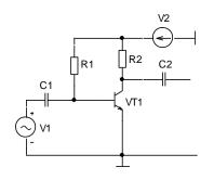
**4.** Приближенным методом рассчитать параметры компонентов для задания режима по постоянному току, обеспечивающего получение максимальной амплитуды выходного напряжения. Напряжение питания 10~B, ток покоя  $I_{c0}$ =1 мA, коэффициент передачи тока транзистора  $\beta$ =50...100
