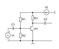
**3.** Приближенным методом рассчитать параметры компонентов для задания режима по постоянному току, обеспечивающего получение максимальной амплитуды выходного напряжения. Напряжение питания 10 B, R3=1 кОм, коэффициент передачи тока транзистора  $\beta$ =30...50
